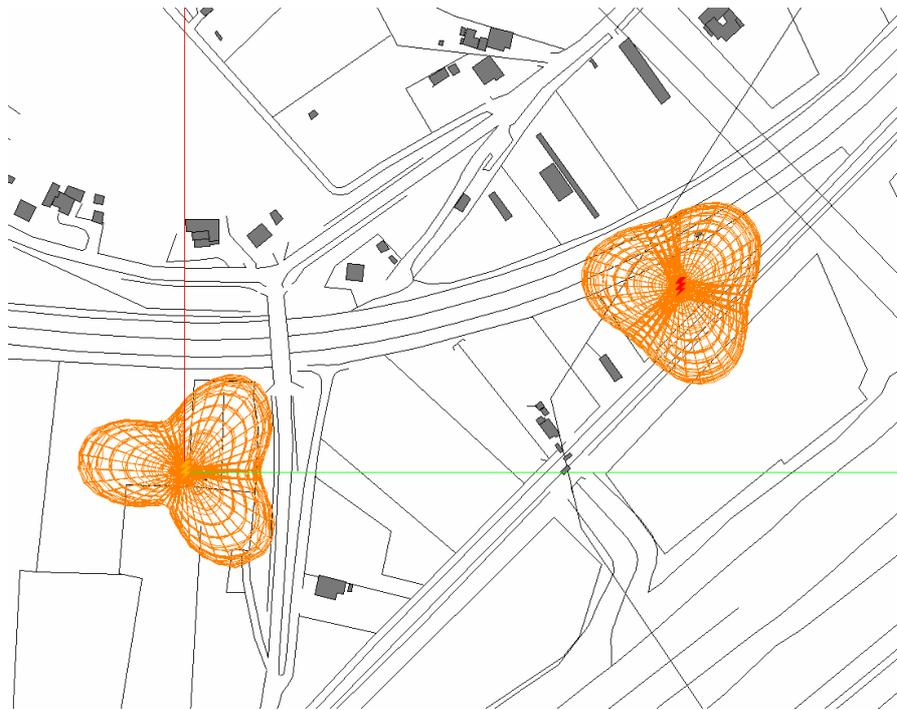
Figura 9.2.2.3 WIND PI032 (a sinistra) e VODAFONE PI3853A – Filettele- Vista in pianta del solido di irradiazione a 6 V/m
