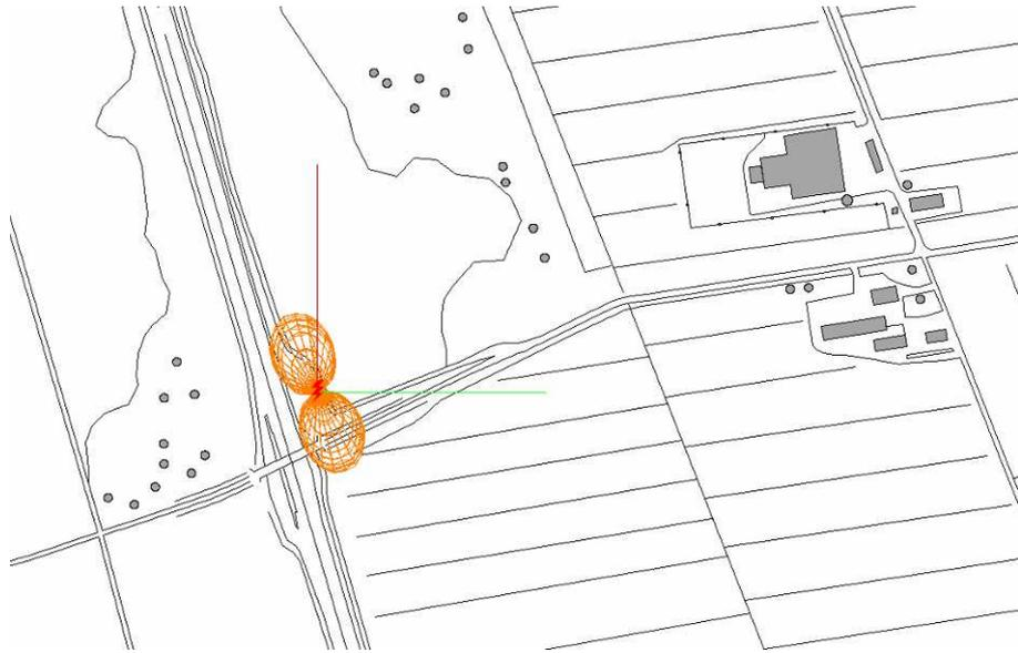
*Figura 9.2.3.3 PI0215C A12 Loc Fagianella - Vista in pianta del solido di irradiazione a 6 V/m*
