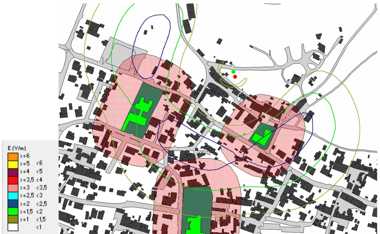
Figura 9.3.3 VECCHIANO OVEST Altezza dal suolo di 2 m - Curve di isolivello
